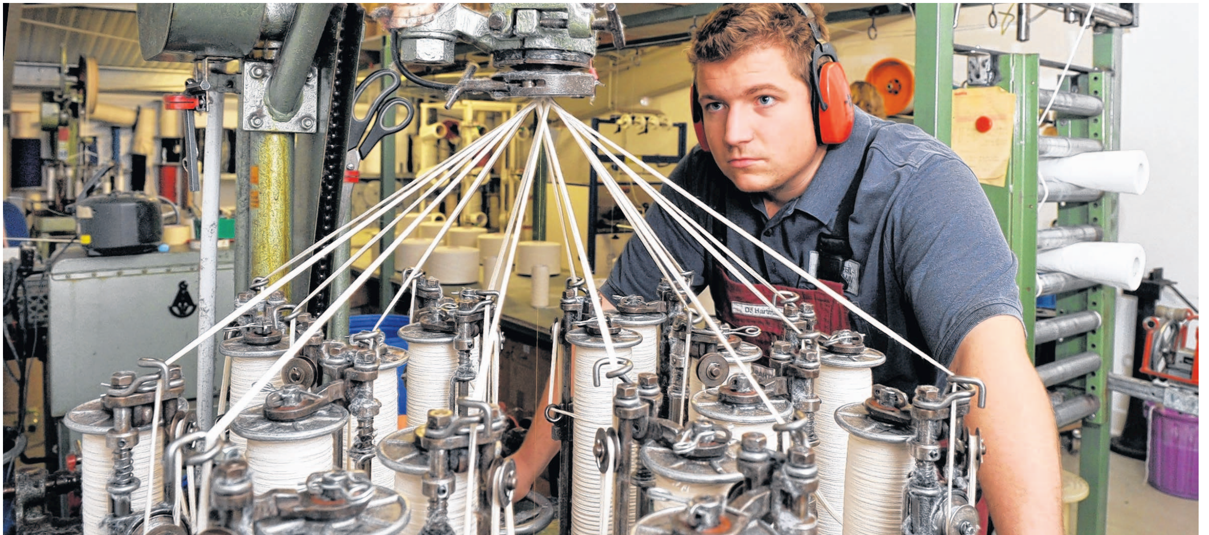
Zurück zu den Wurzeln: Baumwollseile stellt Drahtseil Hartmann mit dieser alten Flechtmaschine, hier bedient von Dominik Hartmann, noch selbst her – und stieg damit in die Erotikbranche ein.
