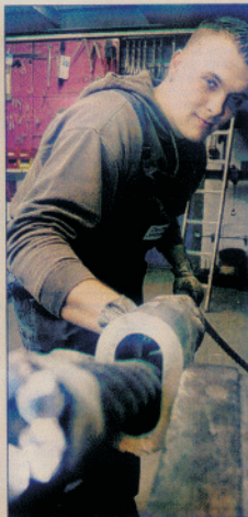
... führt es in eine Öse ein und biegt es zu einer Schlaufe, die er mit einer Klemme schließt.
