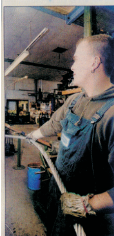
Azubi Manuel zieht das mehrfach gezwirbelte Seil von einer Rolle...
